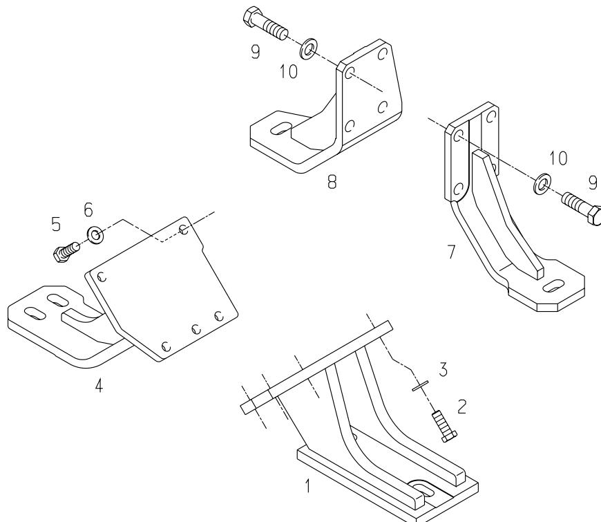
**D 2842 LE410****19-0033****ENGINE MOUNTS****MOTORLAGERUNG****ALLOGGIAMENTO DEL MOTORE**
