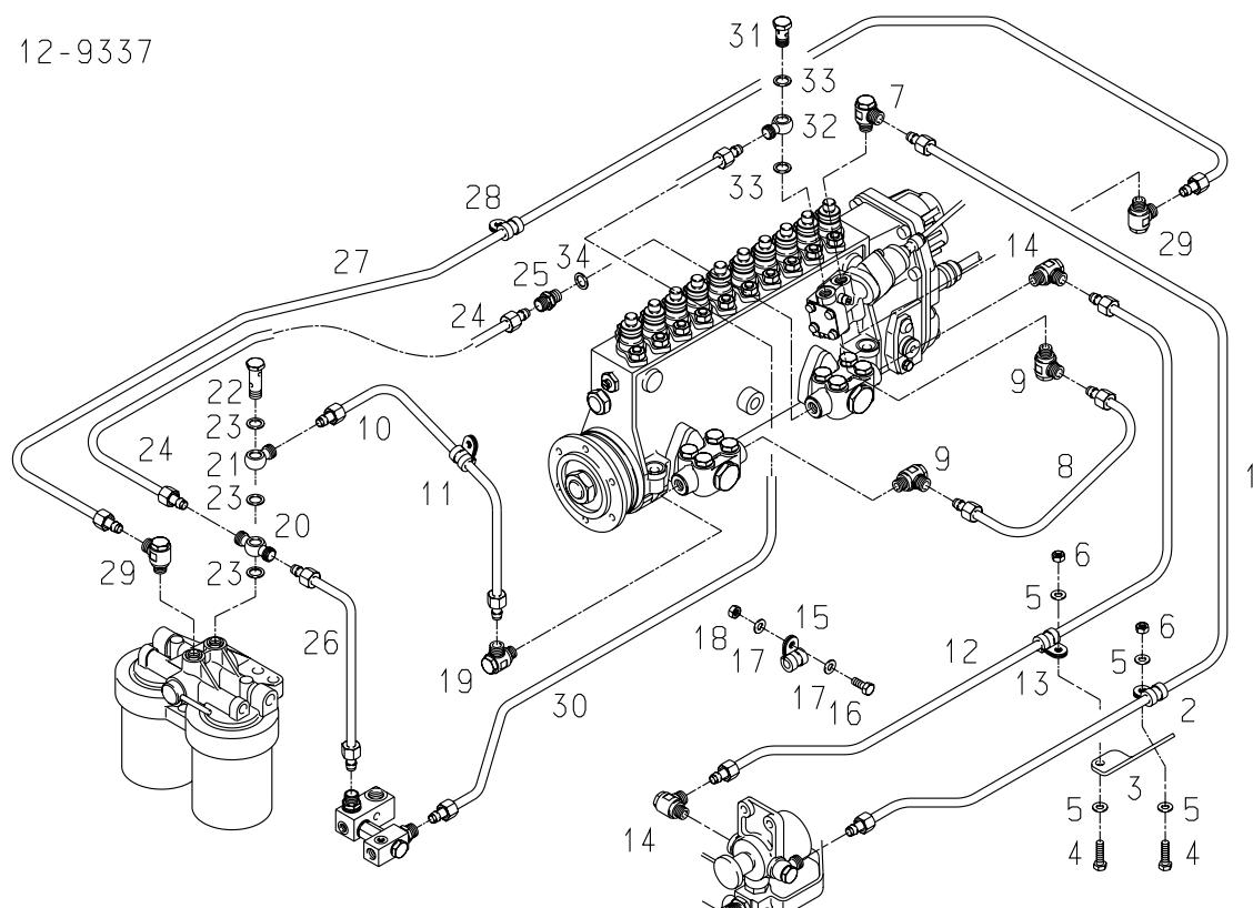
**D 2842 LE410****12-3147****FUEL PIPES****KRAFTSTOFFLEITUNG-EN****TUBAZIONI COMBUSTIBILE**
