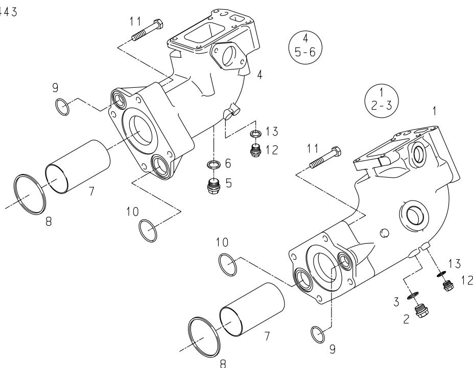
**D 2842 LE410****08-6051****EXHAUST MANIFOLD****ABGASKRÜMMER****GOMITO DI SCARICA**
