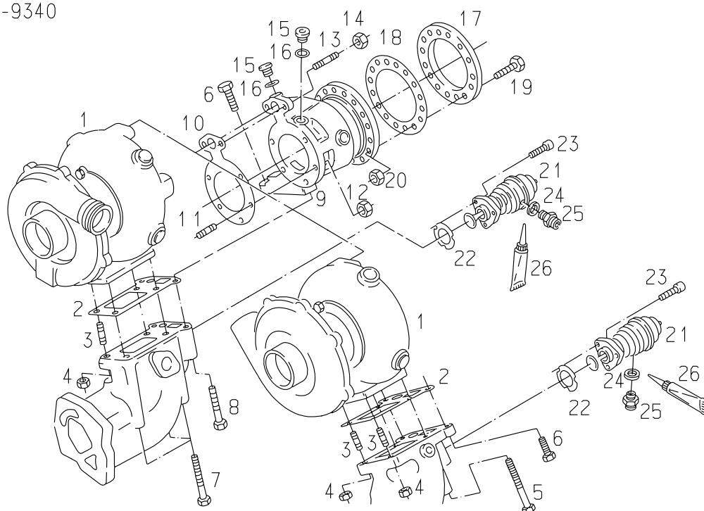
**D 2842 LE410****09-0042****TURBOCHARGER WITH MOUNTING****ABGASTURBOLADER MIT BEFESTIGUNG****TURBOCOMPRESSORE DAS DI SCARICO CON FISSAGGIO**
