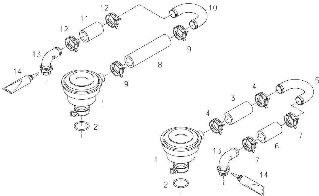
**D 2842 LE410****01-4041****ENGINE BREATHER****MOTORENTLÜFTUNG****SFIATO CARTER MOTORE**
