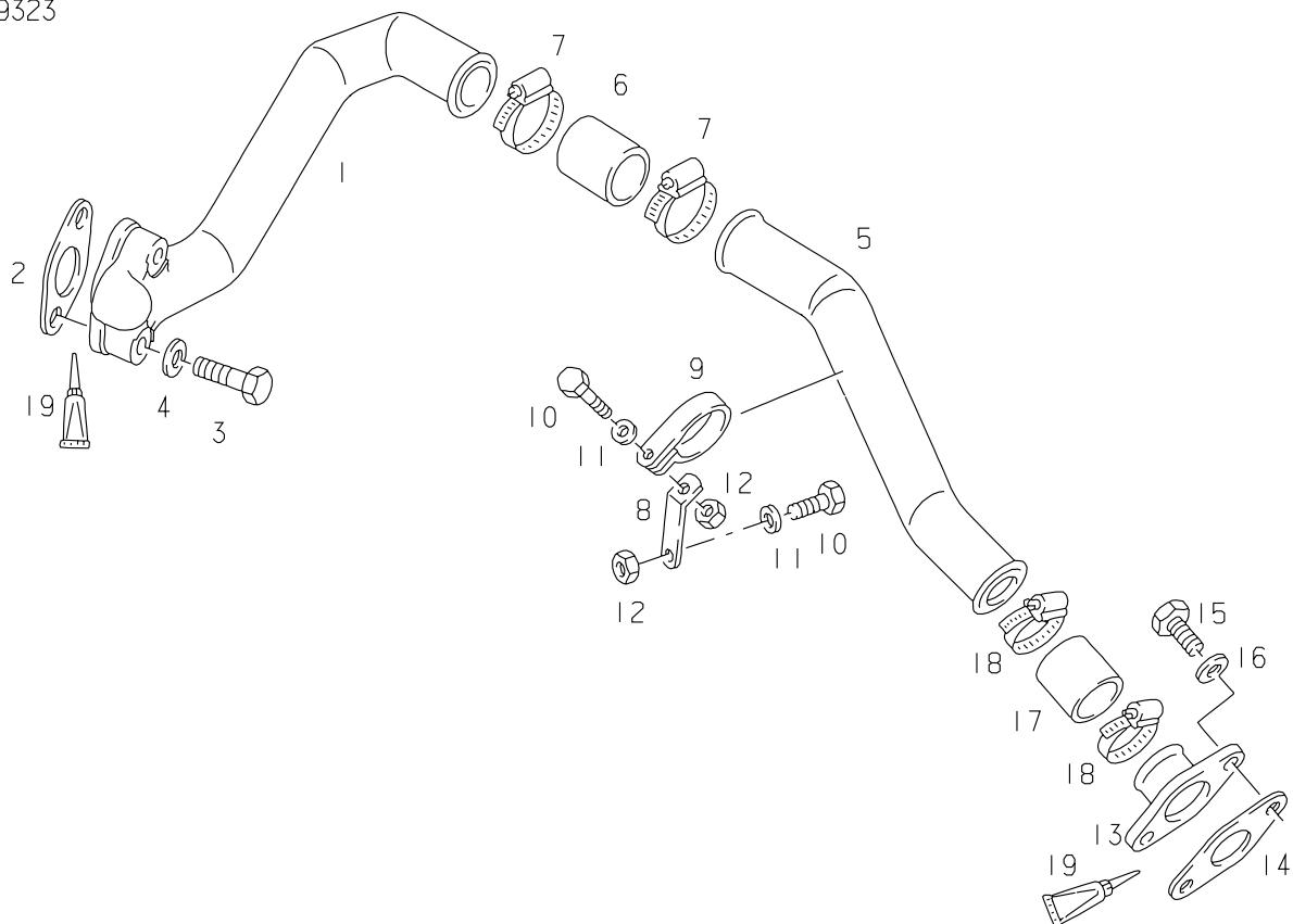
**D 2842 LE410****06-2004****COOLING WATER PIPES****KÜHLWASSERLEITUNG-
