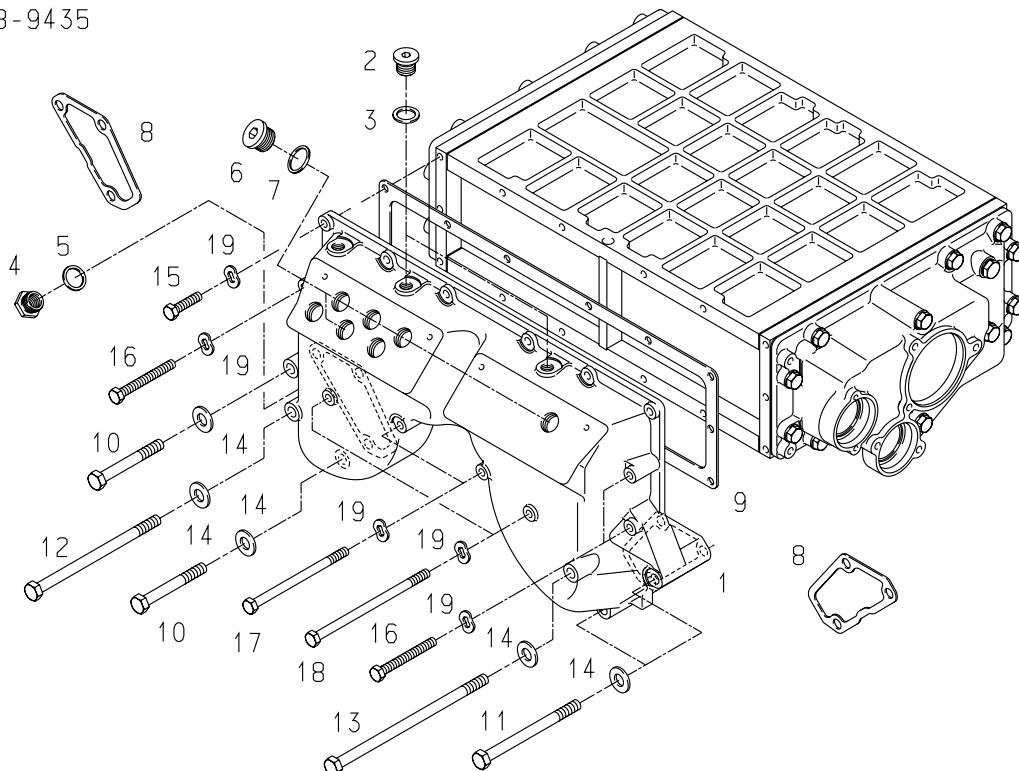
**D 2842 LE410****08-2511****INTERCOOLER ELBOW****LADELUFTKRÜMMER****GOMITO ARIA DI CARICA**
