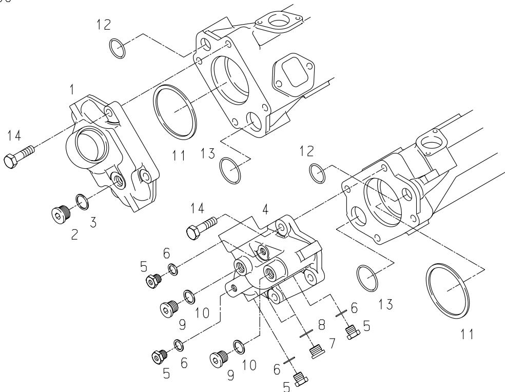
**D 2842 LE410****08-6061****COVER ON EXHAUST PIPE, FRONT****VERSCHLUSSDECKEL AM ABGASROHR, VORN****COPERCHIO SU TUBO SCARICO, ANT.**
