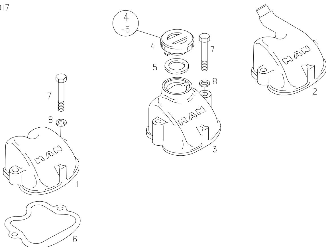
**D 2842 LE410****03-3006****VALVE HOOD****ZYLINDERKOPFHÄUBEN COPERCHIO TESTATA
