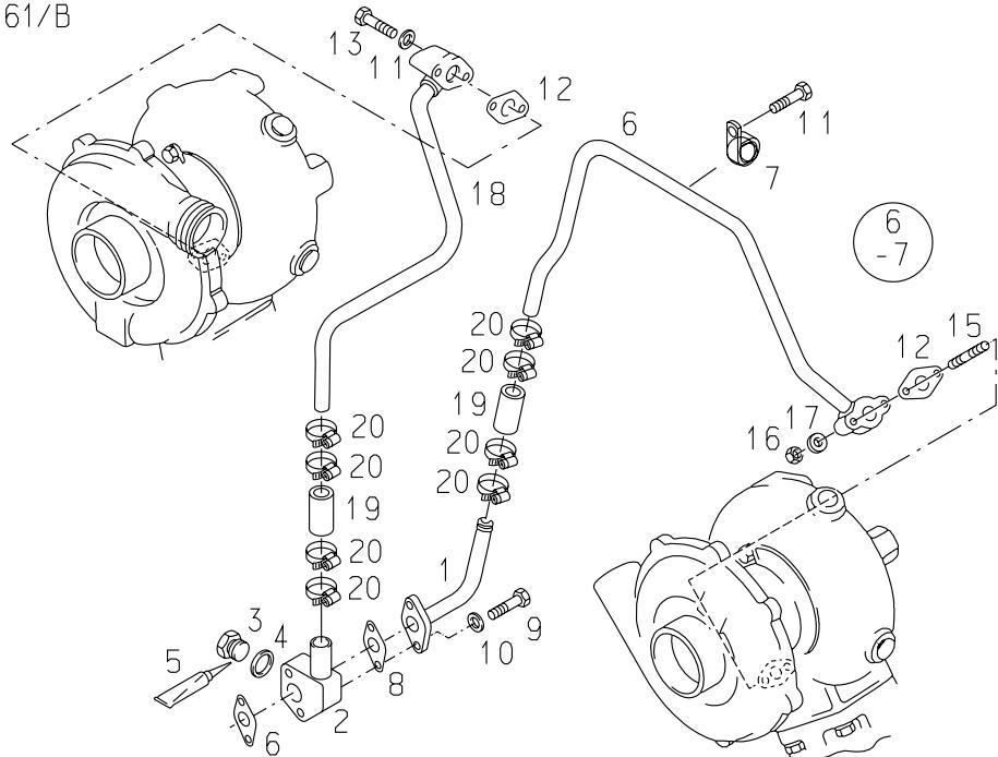
**D 2842 LE410****09-4020****COOLING WATER PIPES****KÜHLWASSERLEITUNG-EN****TUBAZIONI ACQUA RAFFREDDAMENTO**
