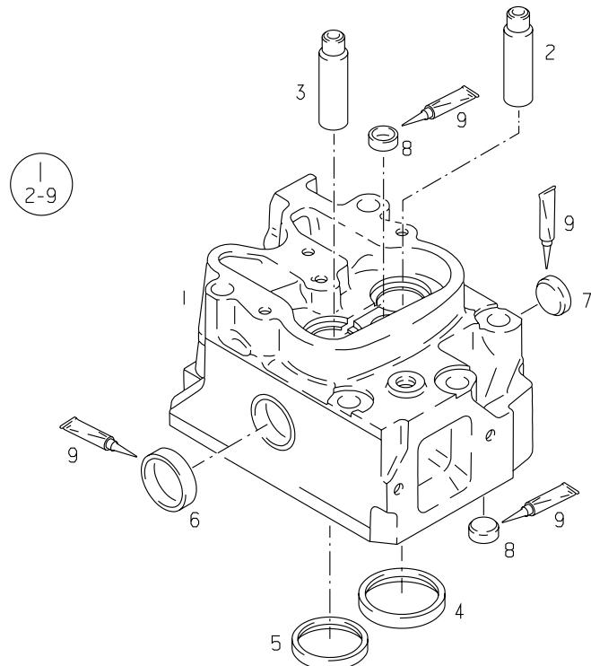
**D 2842 LE410****03-0020****CYLINDER HEAD****ZYLINDERKOPF****TESTATA CILINDRI**
