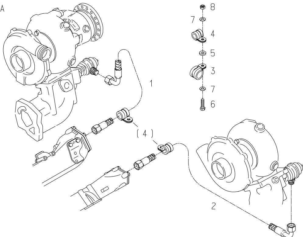
**D 2842 LE410****09-2016****AIR PIPE TO VALVE****LUFTLEITUNG ZUM
